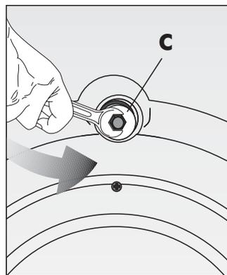
следует выворачивать против часовой стрелки до тех пор, пока их нельзя будет легко вытащить.
