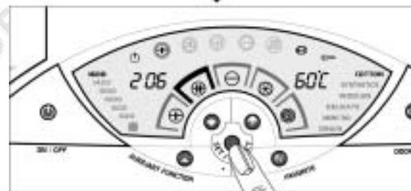
Для того, чтобы включить программу стирки, нажмите кнопку START/STOP при мигающем индикаторе.
