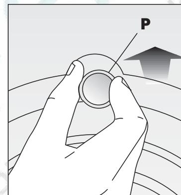
Отверстия для транспортировочных болтов необходимо закрыть прилагаемыми пластиковыми заглушками, имеющими обозначение "Р", как показано на рисунке.
