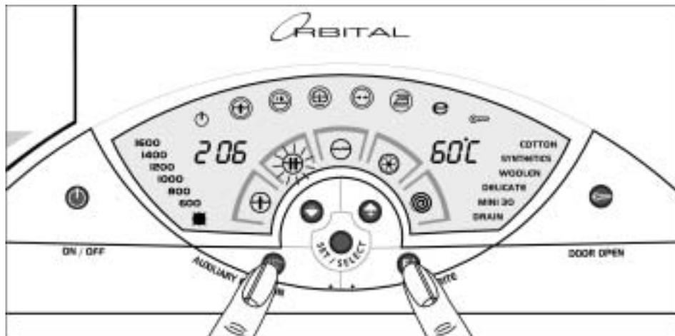
На время стирки Вы можете заблокировать панель управления для того, чтобы случайно не нажать какую-нибудь кнопку. Для включения блокировки нажмите одновременно кнопки “Дополнительные функции” и “Любимая программа” и удерживайте их нажатыми в течение 3 секунд. При этом начнет мигать индикатор этапа программы, который до этого горел непрерывно.
