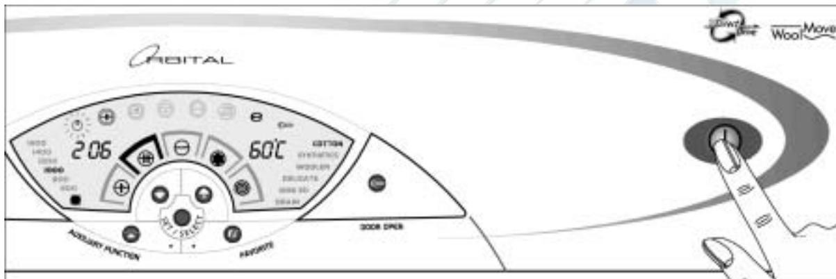
При включении (кнопка “Включить/Выключить”) машина начинает работать в режиме установки программы. На дисплее загораются надписи “Softon” (хлопок), “60°C”, “1000” (об/мин.). Если дверца загрузочного люка закрыта, индикатор дверцы люка горит, индикатор “Старт/Стоп” мигает. При открытой дверце, индикатор мигает.
