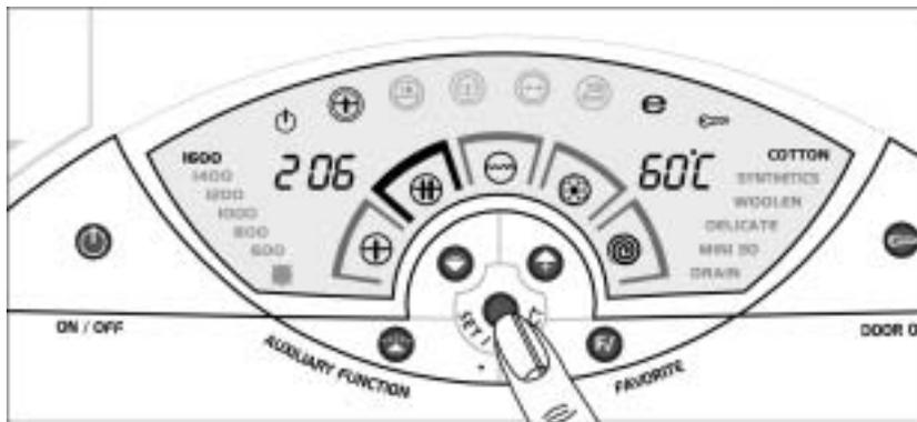
Каждый раз, когда Вы нажимаете кнопку SET/SELECT выбирается очередной параметр работы программы. При первом нажатии на кнопку SET/SELECT красным светом подсвечивается надпись COTTON (хлопок). Остальные значения подсвечиваются зеленым светом.
