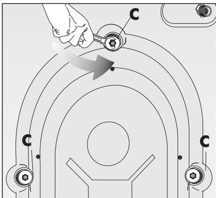
Перед установкой машины на место необходимо снять транспортировочные болты. Болты, на головках которых имеется обозначение "С",
